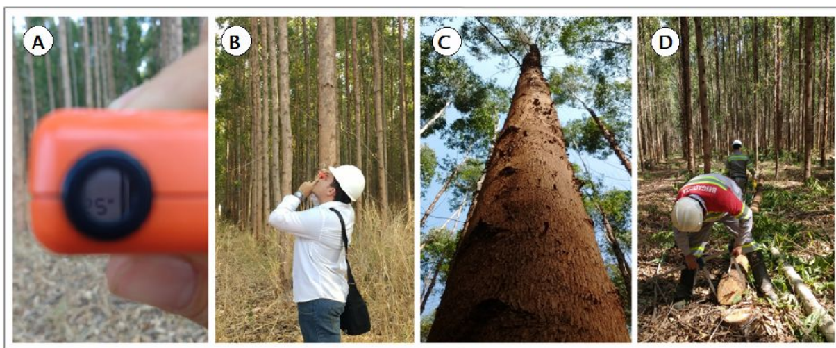
FIGURA 2 Mensuração da altura total das árvores em pé com auxílio do hipsômetro Vertex Håglof (A e B). Aferição do diâmetro a altura do peito da árvore em pé (C). Mensuração dos diâmetros e altura total da árvore abatida (D).
