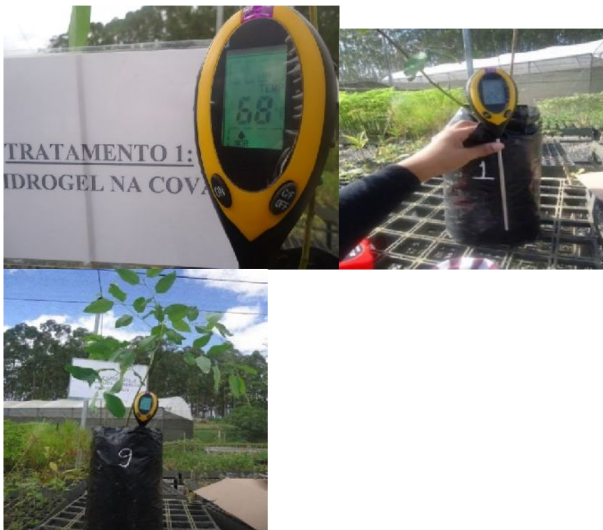
FIGURA 4. (A) Aparelho 4X1 de medir a umidade solo; (B) Aparelho dentro do saco de mudas avaliando a umidade do solo;(C) Representação do tamanho do aparelho. Fonte: Autores, 2019
