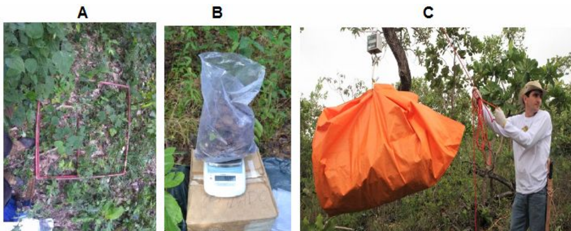
FIGURA 3. Imagens da coleta e pesagem de biomassa; (A) gabarito da subparcela de herbáceas (0,6 x 0,4 m). (B) pesagem em campo da biomassa coletada em balança de precisão. (C) pesagem de grande volume de biomassa com dinamômetro.
